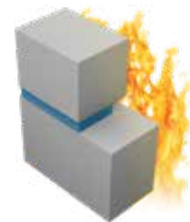
5/6. Enkeltfuge, udsat eller ikke-udsat side
