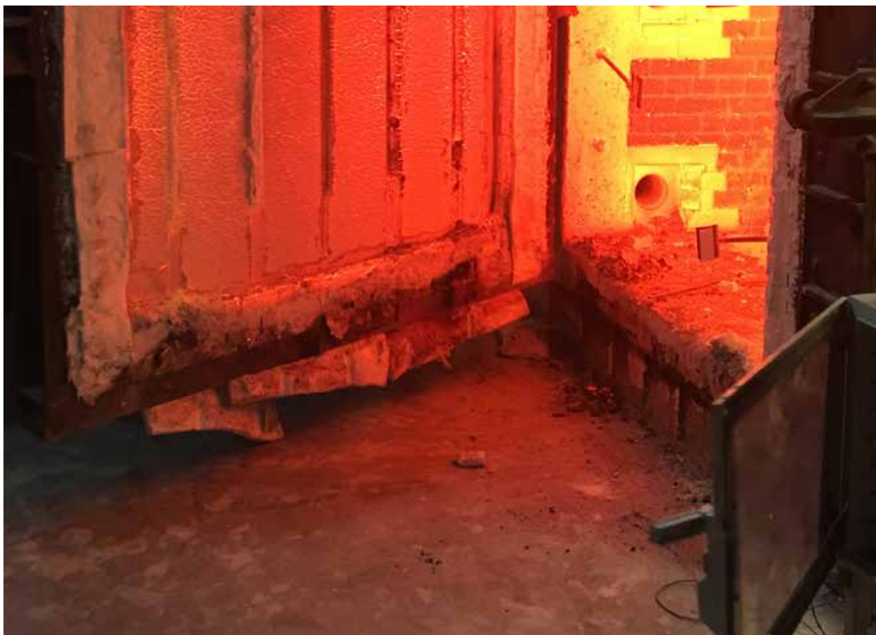
Ovn med lodrette lineære tætninger efter brandmodstandstest i.h.t. EN 1366-4.
