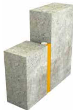
PE-bagstop og brandresistent fugemasse
